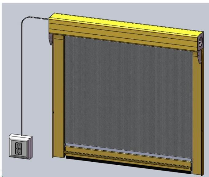
3) Una volta impostati i fine corsa collegare i fili alla pulsantiera in dotazione.
