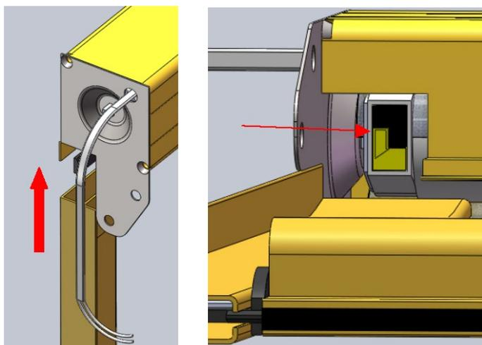
2) Provare a movimentare la zanzariera con una batteria da almeno 14V collegandola al cavo di alimentazione del motore (vedi figura 2). Nel collegare i cavi si presentano due situazioni:
